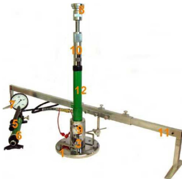
Rys. 1.2 Aparatura VSS z jednopunktowym pomiarem przemieszczenia płyty
