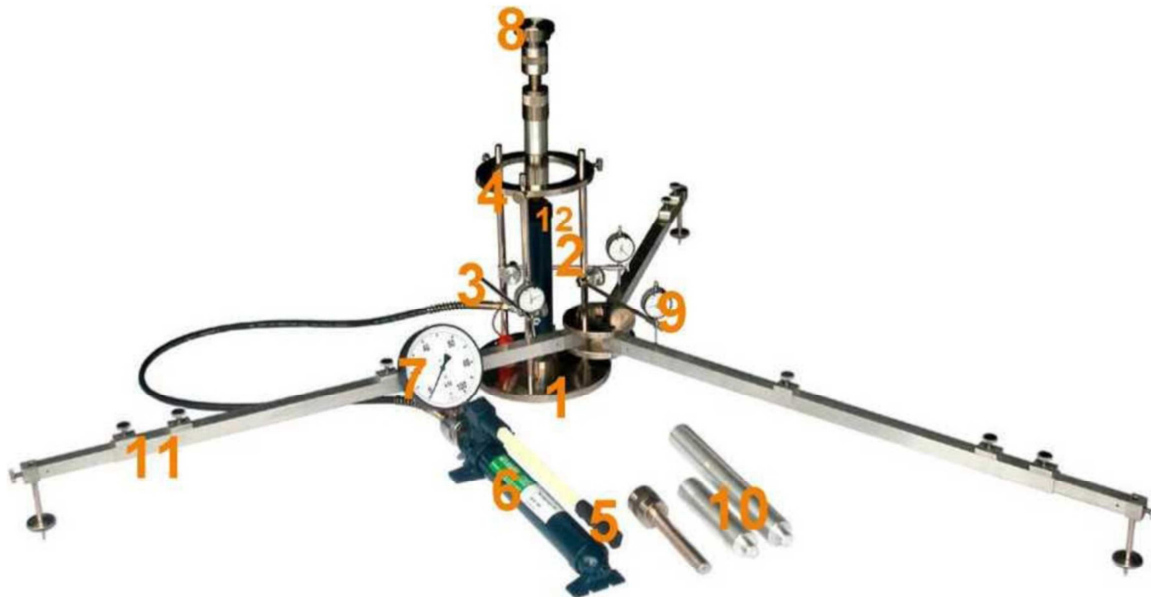
Rys. 1.1. Aparatura VSS z trzypunktowym pomiarem przemieszczenia płyty
